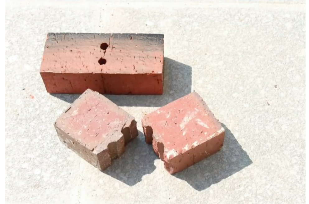
• Homlokzati téglá törésképe. Forrás: Herzog de Meuron
