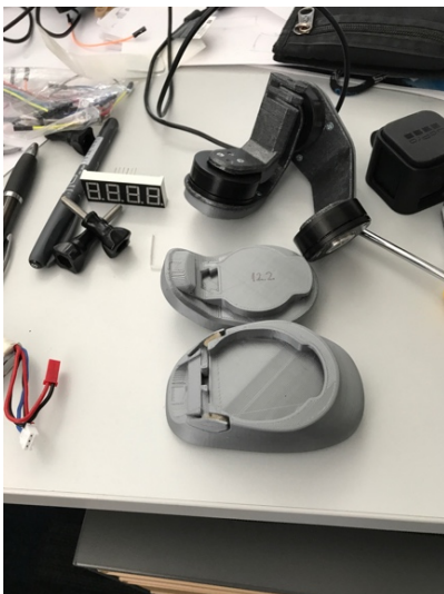
ábra 21 A Maform iroda Rapid Prototyping módszerben tervezett tárgy M1:1 méretarányú 3D nyomtatott modelljei 2017. (saját fotó)
