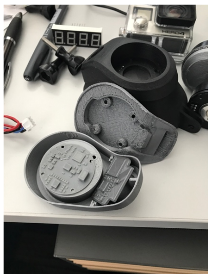
ábra 21 A Maform iroda Rapid Prototyping módszerben tervezett tárgy M1:1 méretarányú 3D nyomtatott modelljei 2017. (saját fotó)
