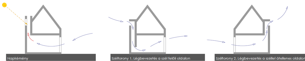
5.4.10. Ábra. Természetes szellőzés 2. : Napkémény, széltorony
