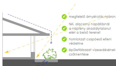
5.5.3. Ábra. Árnyékolás-Túlnyúló esz
