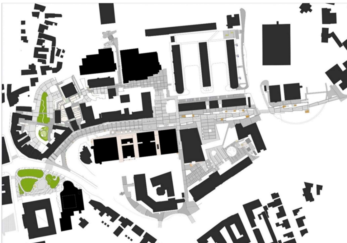
31. Veszprém belváros-rehabilitációja keretében megújult közterületek burkolatosztási terve
