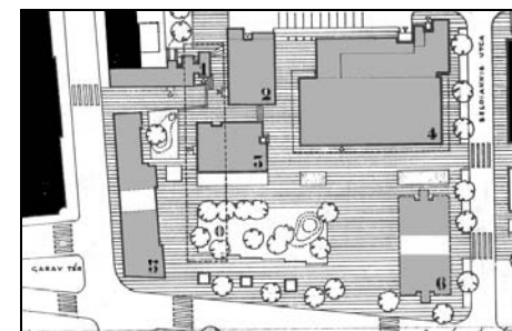
Helyszínrajz az eredeti funkciókkal 1. KPM irodaház, 2. Gelka szerviz, 3. MNB irodaház, 4. Áruház, 5. Felújított műemlék épületek, 6. MSZMP székház
